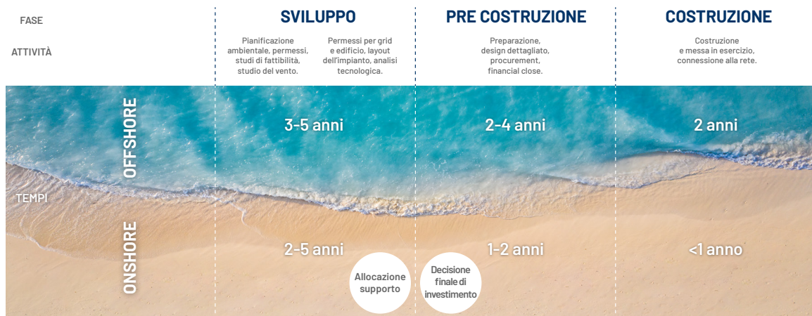
Figura 4 | Il ciclo di vita dello sviluppo di un parco eolico
