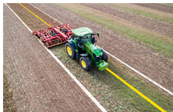
Immagine 3 | Trattore con sistema di guida integrato
